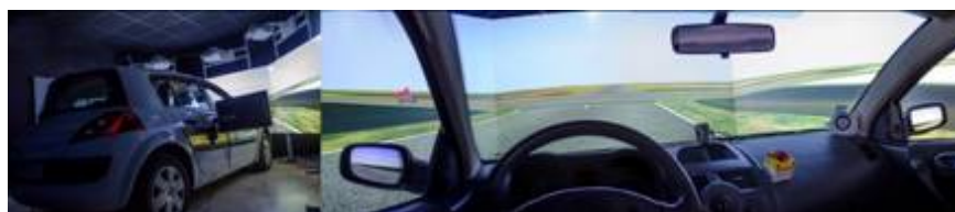
Figure 12: A gauche, le simulateur de conduite vu de l'extérieur avec les 3 rétroprojecteurs et les trois écrans. A droite, le point de vue des participants à l'intérieur de l'habitacle. La scène visuelle est projetée devant le véhicule et apparaît également sur les rétroviseurs.
